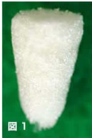
図1 βTCP・CMキチン 複合材料の肉眼像
